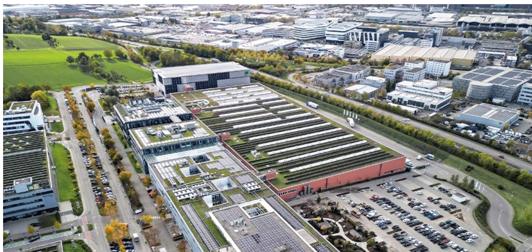
Die Bechtle Konzernzentrale in Neckarsulm punktet als nachhaltiger Standort: Über 7.000 Solarmodule auf allen verfügbaren Dachflächen, 261 Erdwärmesonden unterhalb der Büro- und Lagergebäude, Gebäudetechnik mit natürlichen Kühlmitteln oder 7.500 Quadratmetern Grünanlage. Copyright: Leo Dörfeler
